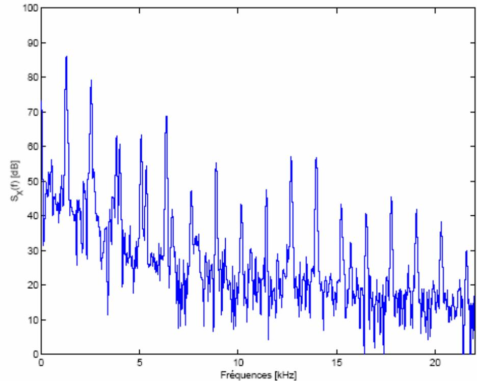
Fenêtres d'analyse **recouvrantes** de 20ms ( $f_e=44.1\text{kHz}$ , 20ms :  $N=882$  échantillons)
